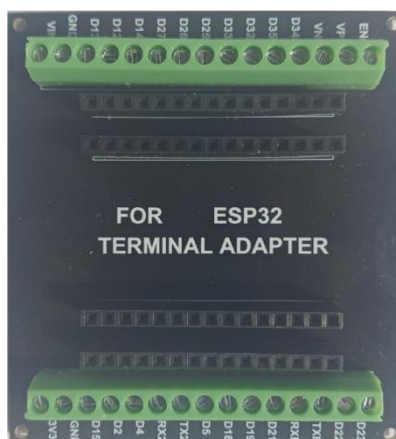
Figura N° 05: Placa de expansión ESP32
